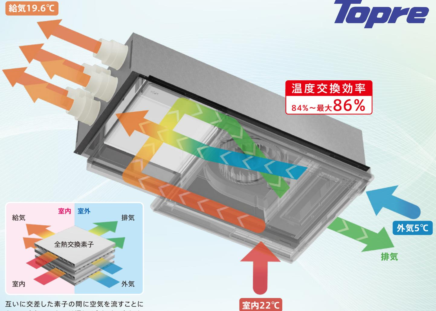
互いに交差した素子の間に空気を流すことによって、空気そのものは混じり合わせる事なく、温度と湿度を交換します。
